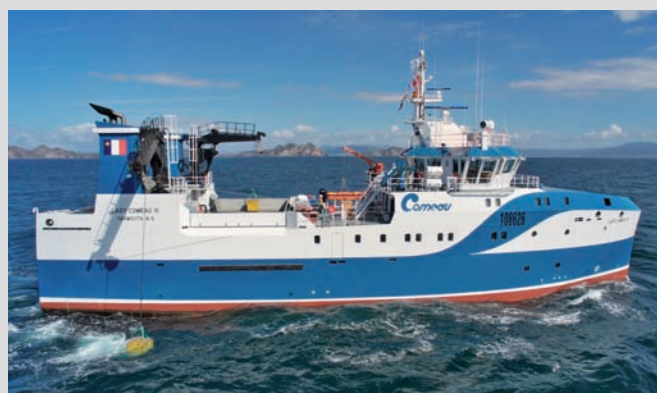
➤ El “Lady Comeau III” navega con los tangones desplegados a ambas bandas. En la imagen se aprecia el rastro de estribor remolcado y asomando a la superficie.
