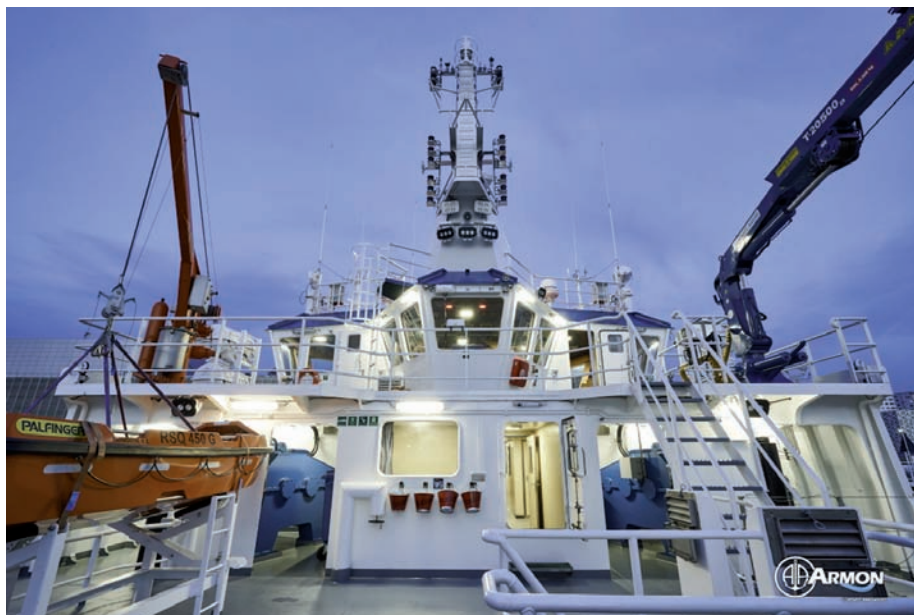
> Desde popa, la grúa de servicio de Toimil y el pescante de Palfinger para operar la embarcación de servicio.
