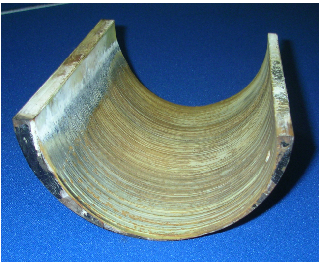
Tipico esempio di usura da abrasivi. ►
