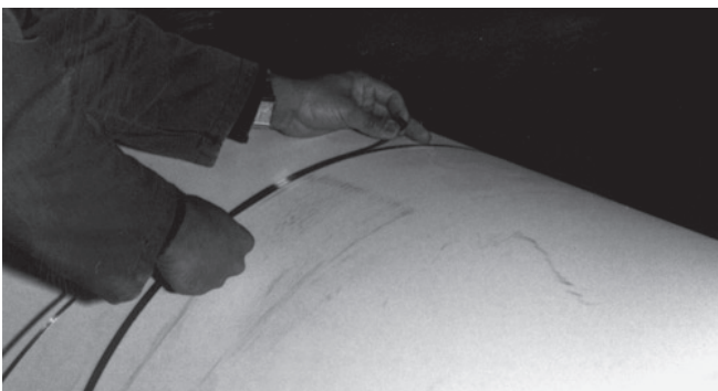
Un calibro per circonferenze è un nastro in acciaio di precisione per rilevare il diametro misurando la circonferenza.
