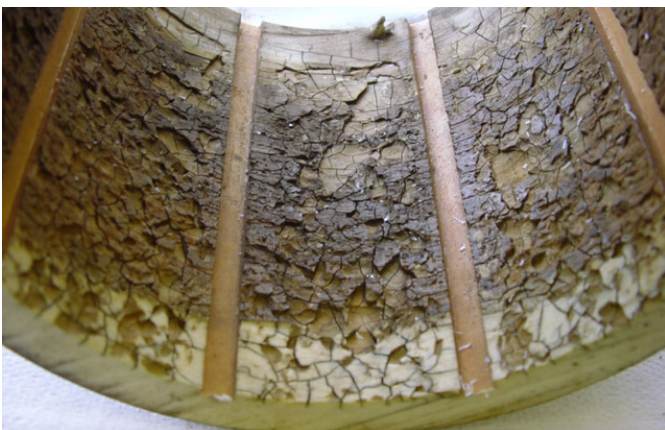
Esempio tipico di cuscinetto con effetto da idrolisi.
