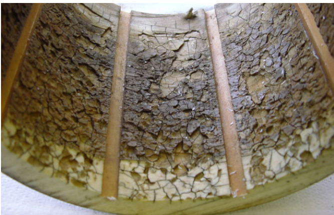
Ejemplo típico de un cojinete con hidrólisis.
