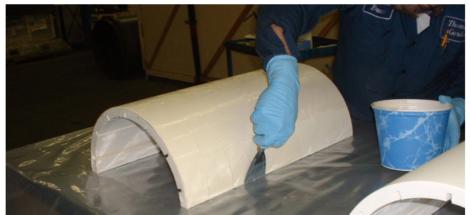
Figura 40: TG-75 siendo aplicado al D.E. de un cojinete SXL dividido
