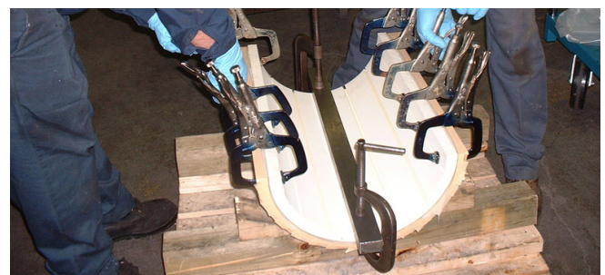
Figura 41: Sujeción del SXL a la carcasa metálica con abrazaderas ejerciendo poca fuerza
