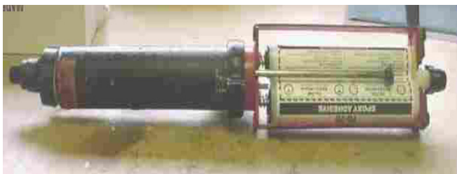
Figura 36: Cartucho de TG-75 bien insertado en la pistola neumática
