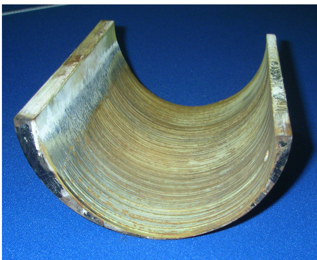
Ejemplo típico de un cojinete con desgaste por abrasión. ►
