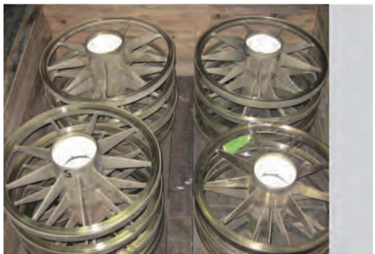
**Подшипники для насосов Thordon SXL, установленные в имеющийся бронзовый корпус**
