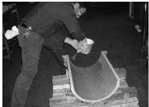
Figura 5: Pegamento aplicado a un alojamiento partido de metal
