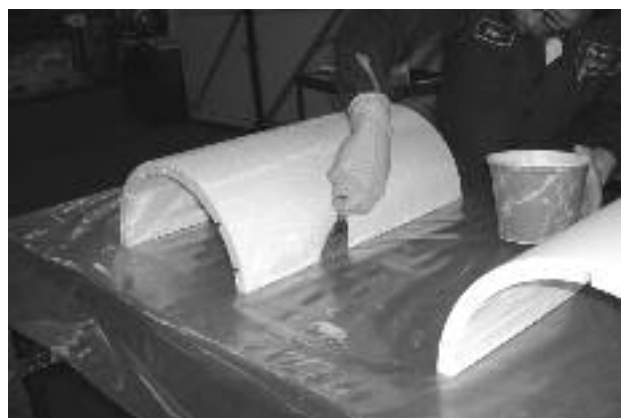
Figura 6: TG75 aplicado al diámetro exterior de un cojinete SXL partido
