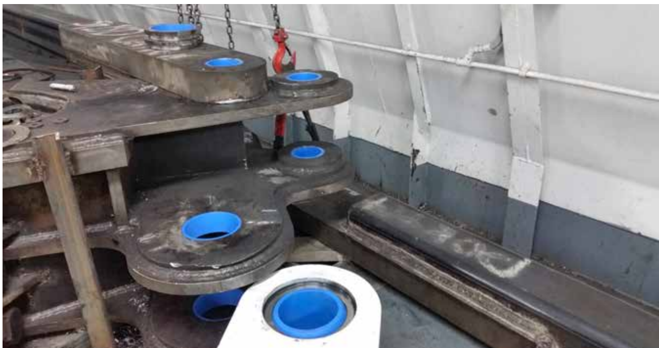
ThorPlas-Blue instalado en el brazo de la caña del timón
